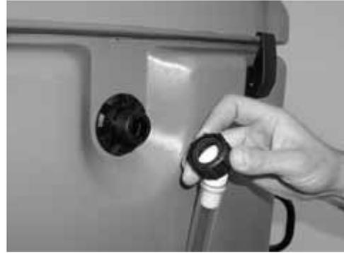
Bild 7-4 Kondensatablauf prüfen
